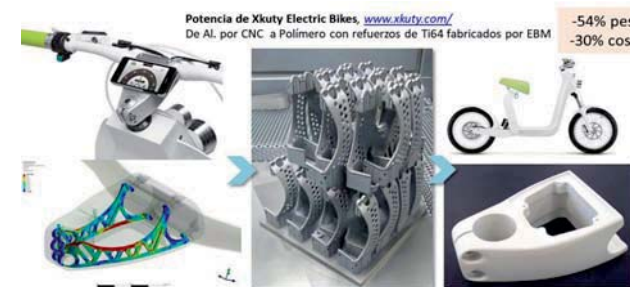
Rediseño de potencia de aluminio de motocicleta eléctrica rediseñada para ser fabricada en polímero con refuerzos internos de Titanio64. El conjunto final logra un ahorro del 54% en peso y un 30% en coste respecto a la misma pieza fabricada en aluminio mecanizado.
