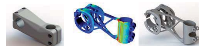
Componente estructural de bicicleta optimizado con un ahorro del 83% de material respecto al diseño original, diseño optimizado para ser producido por tecnología EBM.
