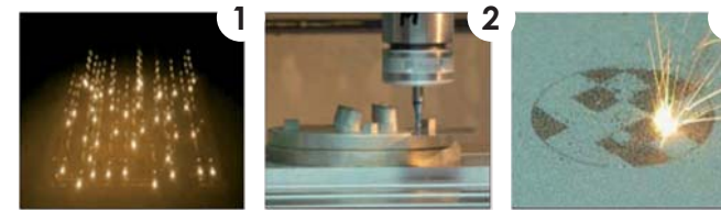
1: DESARROLLO DE TECNOLOGÍA EBM DE ALTA RESOLUCIÓN HISRESEBM. El objetivo de este proyecto fue desarrollar una tecnología EBM de mayor resolución, el papel de AIDIMME fue desarrollar un sistema de reparto de polvo mejorado respecto al estándar para esta tecnología. (ARCAM AB, EUROCOATING SPA, SPARK POWER LTD, LPW Technology Ltd, TWI LIMITED y AIDIMME)
