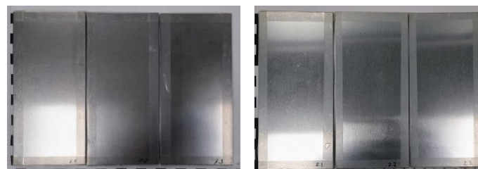
Figura 6. Muestras de acero (izda.) y zinc (dcha.) antes del ensayo de corrosión acelerada.
